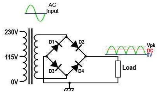
Fig. 1.1.4 The Bridge Rectifier
