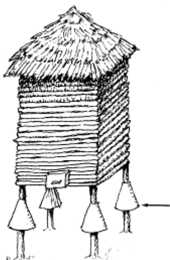
改善储存食物的方法 (装上金属管套以防止老鼠)
