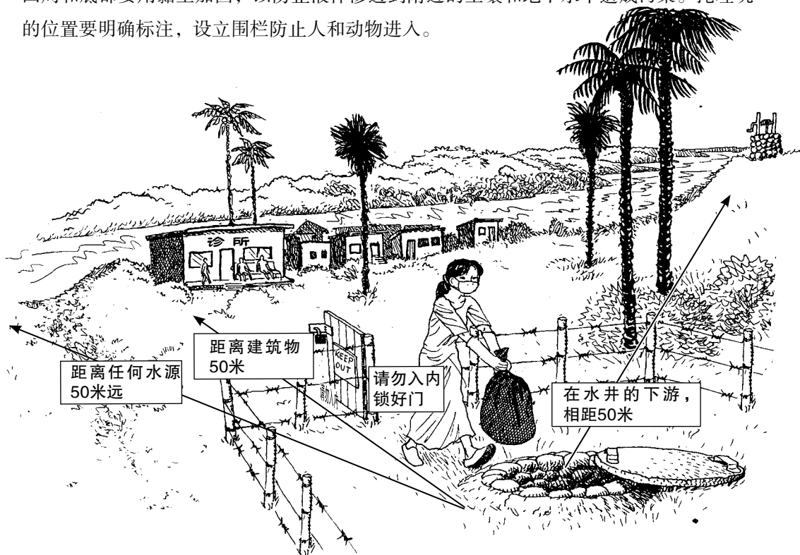
修建废弃物填埋坑时，遵循“50米”原则。
