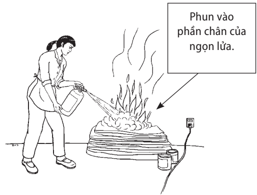
Một bình chữa cháy có thể nhanh chóng dập tắt đám cháy nhỏ.
