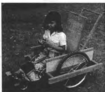
Деревянное кресло-коляска из Таиланда. Велосипедные колесные оси поддерживаются с обеих сторон, чтобы предохранить их от изгиба.
