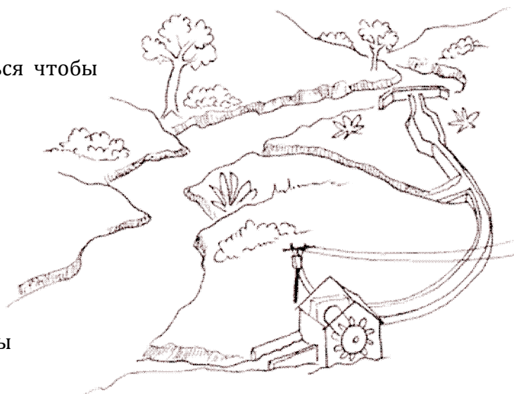
Вода из реки спускается вниз к турбине, и затем возвращается в реку
