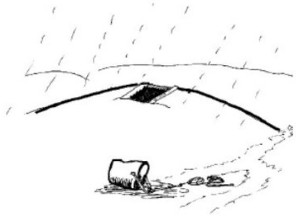
2. Отверстие колодца построено так, что не позволяет затекать воде снаружи
