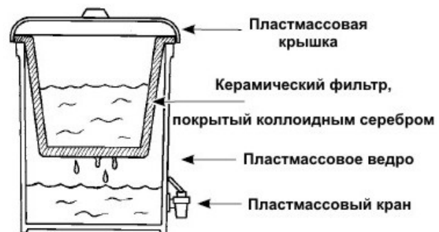
Керамический фильтр, используемый в пластмассовом ведре
