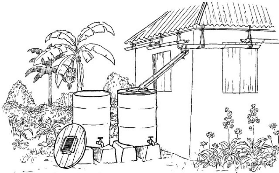
Использование жестяных крыш для сбора дождевой воды
