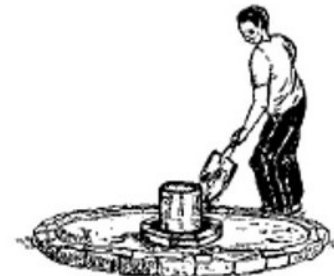
Залейте бетон в форму плиты и сделайте форму защитного воротника (кольца).
